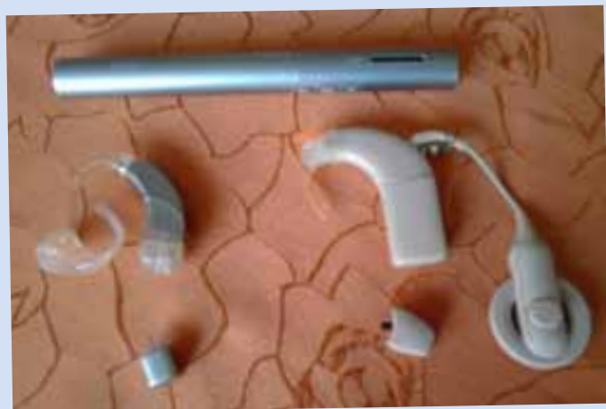
Der „Roger Pen“ mit den dazu passenden Empfängern für CI und Hörgerät
