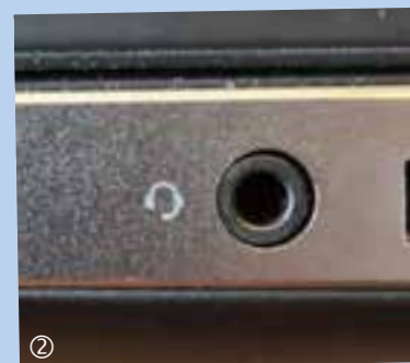
Neuere Laptops (unten) haben nur einen Kopfhörerausgang, ältere (oben) zusätzlich eine Buchse für ein externes Mikrofon
